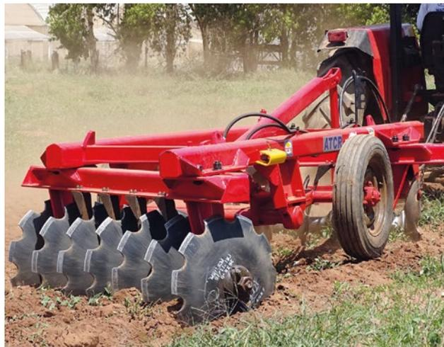
**Mancais** com dois rolamentos de rolos cônicos, lubrificadas a graxa (CM) ou em banho de óleo permanente - DUROMARK® (DM), que utilizam retentores Duo-Cone, sem vazamentos e sem contaminação por materiais abrasivos. A troca de óleo a cada mil horas economiza lubrificante e mão de obra, evitando paradas diárias.
