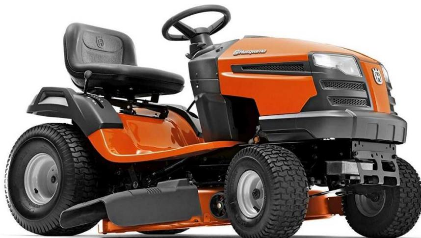
Es un tractor con transmisión hidrostática y equipado con una eficaz unidad de corte de 97 cm de ancho (38"). El tractor Husqvarna TS138L tiene un potente motor marca Husqvarna de 17 hp, para trabajo pesado, con un fácil ajuste de la altura de corte para diferentes tipos de pasto de mezclas de forraje (familias: poaceae, fabaceae, etc.). La tecnología de corte por inducción de aire mejora el flujo de aire dentro de la plataforma, asegurando un corte limpio y constante en todo momento.
