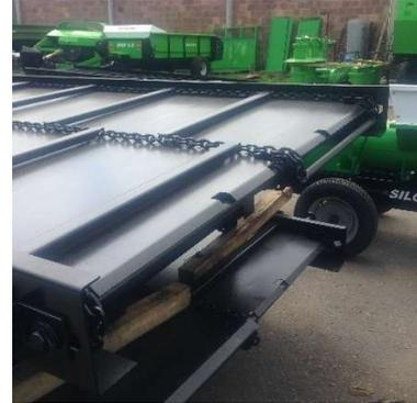
El eje motor se distingue porque es un eje fijo y tiene un sistema de mecanismos que hace que se mueva toda la estera del piso. Este eje tiene 2 chumaceras laterales y generalmente una central que deben ser engrasadas diariamente. En el caso del eje motor gira todo el eje con los sprockets (piñon en donde apoya la cadena).
