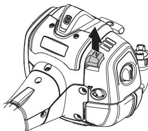
Desmonte la cubierta del filtro de aire y retire el filtro. Límpielo con aire comprimido.
