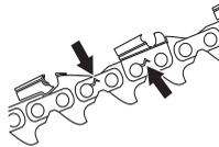
Para comprobar el desgaste de la cadena que utiliza, le recomendamos que la compare con una cadena nueva. Cuando sólo queden 4 mm (5/32 de pulgada) de longitud de diente cortante, la cadena está gastada y debe cambiarse.
