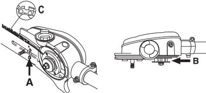
Tense la cadena enroscando a derechas el tornillo tensor de cadena. Utilice la llave combinada o atornille a mano.
