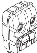
En países con clima cálido y seco, puede ser grande el riesgo de incendio. Por eso, hemos equipado ciertos silenciadores con cortafuegos. Controle si el silenciador de su máquina lo tiene.
