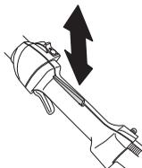
Compruebe que el acelerador y el fiador se muevan con facilidad y que funcionen sus muelles de retorno.
