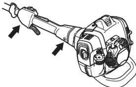
El sistema amortiguador de vibraciones de la máquina reduce la transmisión de vibraciones entre la parte del motor/equipo de corte y la parte de los mangos de la máquina.
