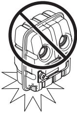
Compruebe regularmente que el silenciador esté firmemente montado en la máquina.
