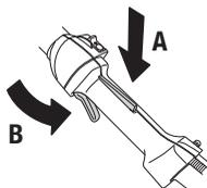
Compruebe que el acelerador esté bloqueado en la posición de ralentí cuando el fiador está en su posición inicial.
