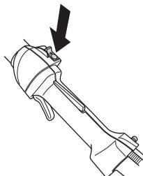
**¡NOTA!** El contacto de parada retorna automáticamente a la posición de arranque. Por consiguiente, antes de realizar trabajos de montaje, control y/o mantenimiento se debe quitar el capuchón de encendido de la bujía para evitar el arranque imprevisto.
