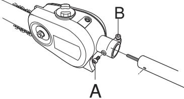
¡NOTA! Asegúrese de que el eje propulsor en el tubo se introduzca en la muesca del cabezal de corte.
