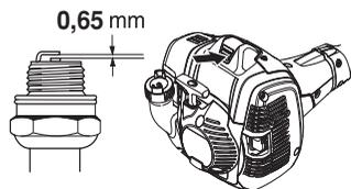
**¡NOTA!** ¡Utilice siempre el tipo de bujía recomendado! Una bujía incorrecta puede arruinar el pistón y el cilindro. Asegúrese de que la bujía tenga supresión de perturbaciones radioeléctricas.
