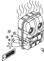
En silenciadores sin catalizador, el apagachispas se debe limpiar y cambiar una vez por semana, si es necesario. En silenciadores con catalizador, se debe controlar el apagachispas y limpiarlo, si es necesario, una vez por mes. **Si el apagachispas presenta daños, se debe cambiar el apagachispas.**
