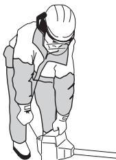
**¡NOTA!** No poner ninguna parte del cuerpo en la superficie marcada. El contacto puede causar quemaduras en la piel o sacudidas eléctricas si el excitador de ignición es defectuoso. Utilice siempre guantes protectores. No emplee nunca una máquina con un excitador de ignición defectuoso.
