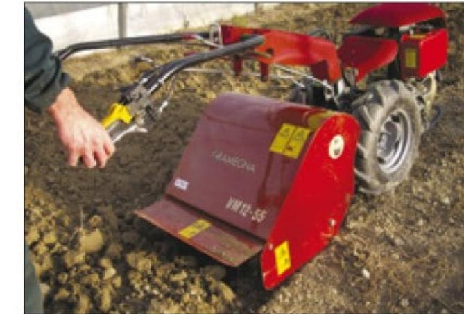
ITALY La regolazione delle slitte di appoggio e dell'ala posteriore permettono di variare facilmente la profondità ed il grado di affinamento del terreno. La VM12 assorbe poca potenza, non produce suola di lavorazione, lascia il terreno ben livellato e rispetta la struttura del terreno.
