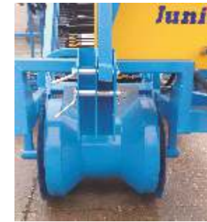
Dispositivo pick-up per scavo patate Detail of pick-up potato digger Dispositif d'arrachage pour pommes de terre Pick Up-Rodesystem Recogedor, sistema de excavación
