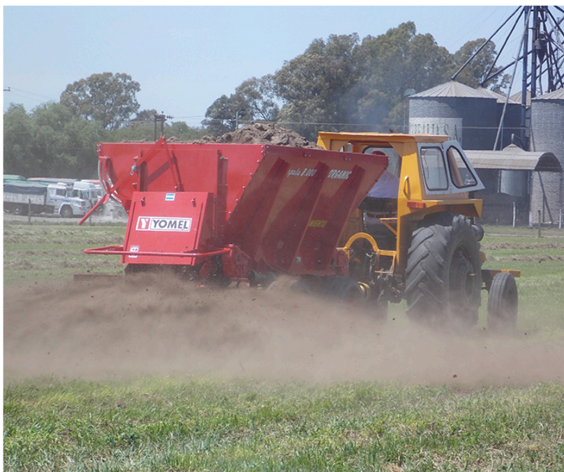
Distribución bidisco con 8 paletas reforzadas.
