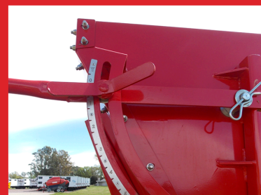
Compuerta trasera para regulación de dosis.
