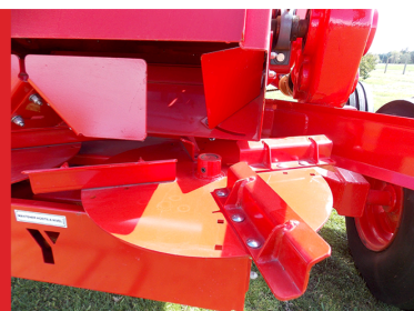
Distribución bidisco con 8 paletas reforzadas.
