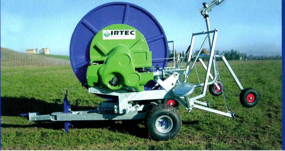
**H** Sistema de compensacion de velocidad del enrollado de la manguera PE accionado por un palpador que segun las filas de manguera enrolladas, abre la valvula by-pass manteniendo constante la velocidad de enrollamiento.
