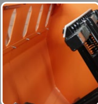
Revestimiento interno en acero especial
