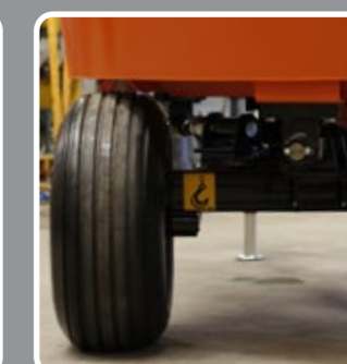
Chasis independiente: Todo esfuerzo del conjunto de mezcla no es absorbido por el chasis.
