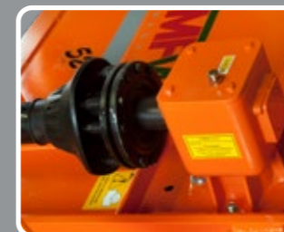
Caja de transmisión de giro libre y cardan de embrague
