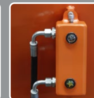
Visor del nivel de aceite del reductor
