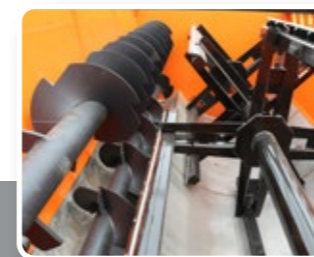
Rotor de gran tamaño segmentados y raspadores intercambiable y reemplazable
