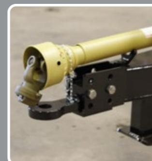
Cardan con pin de seguridad
