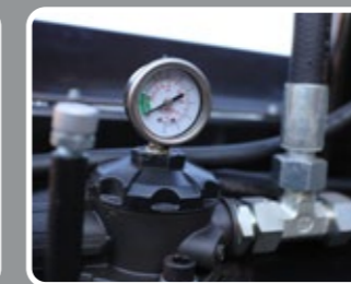
Filtro de retorno en sistema hidráulico
