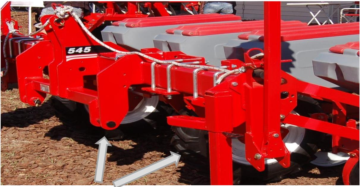
Semi montada se apoya en dos ruedas de tracción,
