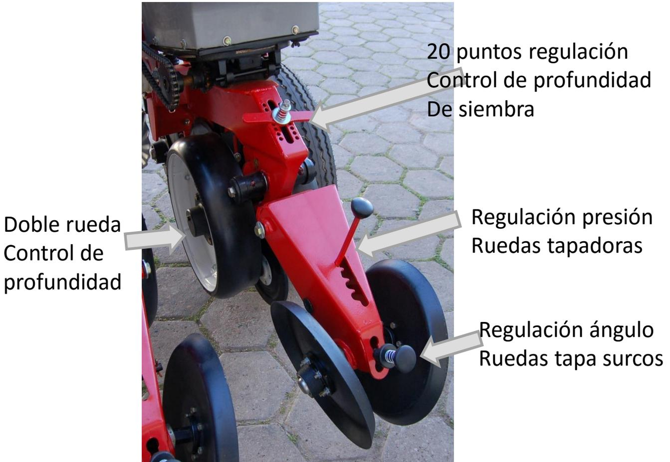
El cuerpo de siembra de la CH 545, esta montado sobre un Paralelogramo largo y ancho, lo que permite un perfecto copiado del terreno sin afectar la distancia entre semillas.
