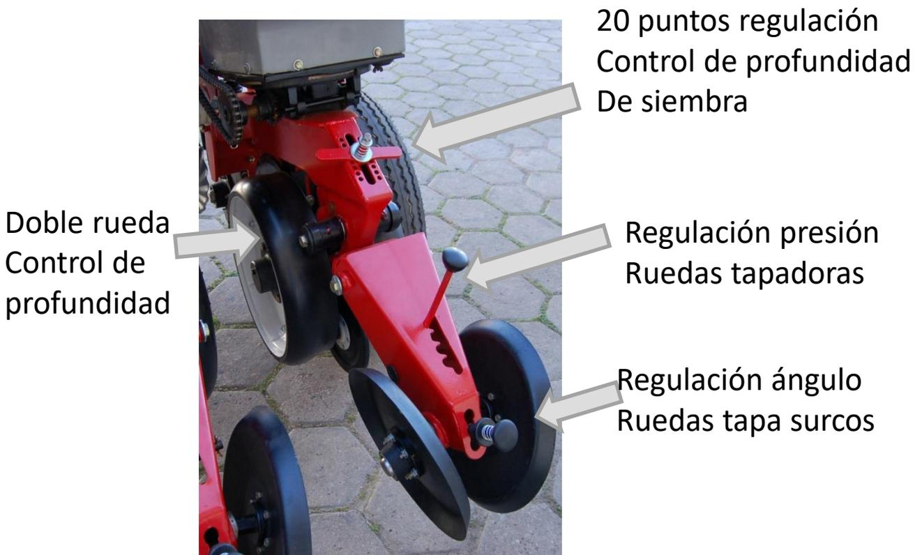
El cuerpo de siembra de la CH 745, esta montado sobre un Paralelogramo largo y ancho, lo que permite un perfecto copiado del terreno sin afectar la distancia entre semillas.
