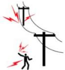
25- Al activar el sistema de salida de la cosechadora, verificar que no haya se encuentra por debajo de la red de electrificación.
