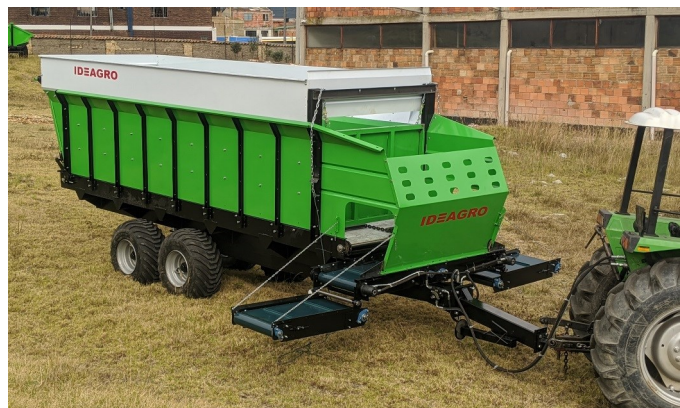
Frontal con compuerta, salida a los dos lados y norias
