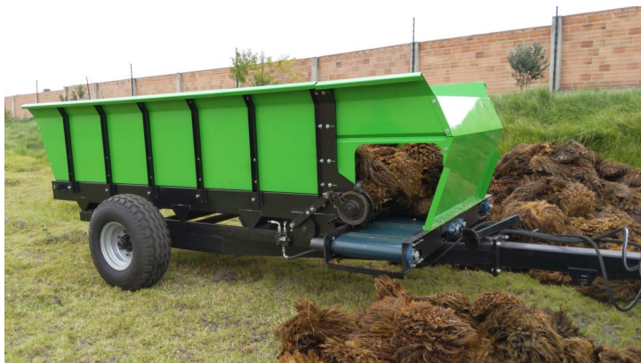
Frontal con compuerta y salida a los dos lados
