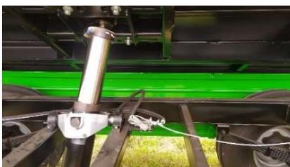
Cilindro hidráulico telescópico con limitador de carrera que permite graduar la descarga lateral y trasera, y evitar accidentes por mala operación.
