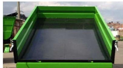
Diseño del compartimiento trapezoidal. Esto facilita su descarga.
