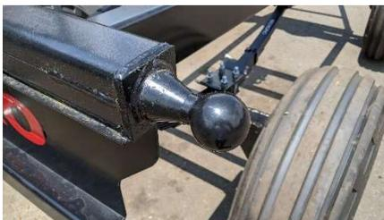
Pivotes redondos con capsulas de nylon para baja fricción y duración. No necesitan engrase ni mantenimiento.
