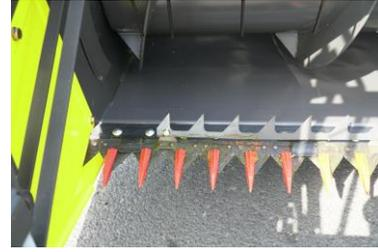
**Cortadoras:** Usando un cortador de 2,5-3,0 mm de espesor y un protector de hoja de electroforesis de alta calidad. El deslizamiento entre el cortador y el marco es más flexible, la paja se corta rápidamente y la pérdida de energía cinética es menor..
