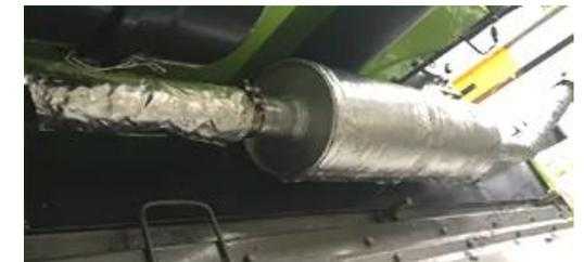
El silenciador y la protección de sellado se agregan en la unión del tubo de escape y el motor para reducir el ruido, lo cual es seguro y confiable.
