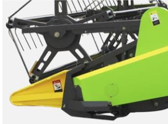
**Diseño Antibobinado:** Tubo antibobinado + placa antibobinado + tablero de protección anti-bobinado, que previene efectivamente el bobinado
