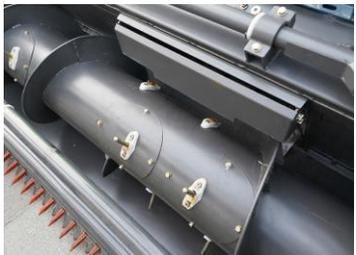
**Feeding auger:** La hoja del sinfín se agrega con un diseño de acero redondo y un proceso de tratamiento térmico local para mejorar la resistencia al desgaste del sinfín de alimentación.
