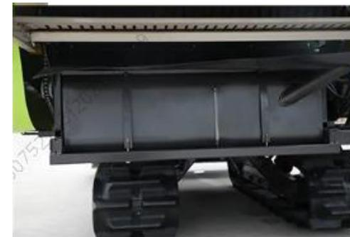
El tanque de combustible se expande a 160L, lo que puede cumplir con los requisitos de operación de más de 10 horas y reduce efectivamente el impacto en la eficiencia operativa debido al reabastecimiento de combustible frecuente.
