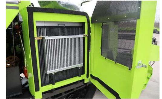
Estructura de radiador optimizada, con alto coeficiente de transferencia de calor y conductividad térmica, gran área de disipación de calor y buen efecto de enfriamiento, evitando altas temperaturas. Se optimizó la estructura de la cubierta del radiador mediante el uso de una esponja de rebote crónico para sellar en todas las direcciones, evitando de manera efectiva que entren residuos en el radiador y evitando afectar la eficiencia de disipación de calor.
