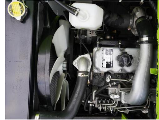
Motor turboalimentado de 4 cilindros de 110 hp, con una reserva de par del 20%, bajo consumo de combustible y rendimiento confiable.
