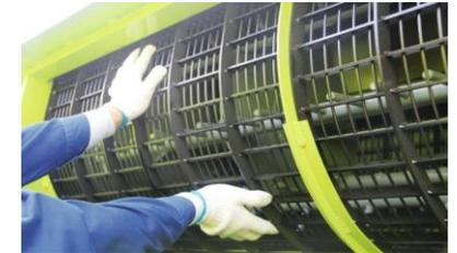
La cubierta de la trilladora adopta un diseño de estructura de unidad, que es conveniente para el desmontaje y montaje y el mantenimiento estable.
