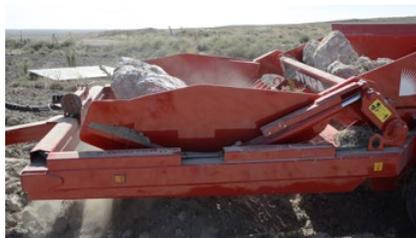
El funcionamiento del rastrillo y de la tolva es totalmente hidráulico, lo que facilita mucho el manejo de la despedregadora.
