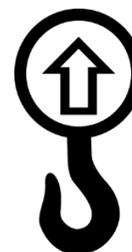
Puntos por donde se debe levantar la máquina con un medio mecánico, para su mantenimiento.
