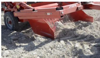
Durante la fase de trabajo, los dientes del rastrillo recogedor situado en la parte frontal de la despedregadora van peinando el terreno a una **profundidad de unos 5 – 10 cm**, recogiendo las piedras que van encontrando. Una vez recogidas se eleva el rastrillo para depositar las piedras en la tolva situada en la parte posterior de la máquina. Cuando la tolva está llena de piedras, se descarga en un remolque o en la orilla del terreno.
