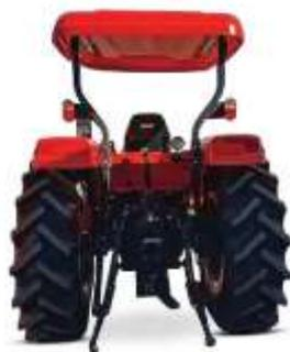
El tractor RX7630 cuenta con dos cilindros de elevación hidráulicos externos con una capacidad de levante de 2256 kgf.
