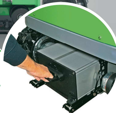
Operazione sostituzione pacco batteria Battery pack replacement operation
