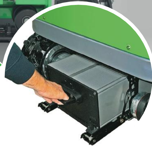
Opération de remplacement du bloc-batterie Austausch des Akkupakets
