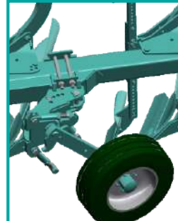
Ruota centrale di sola profondità reversibile in gomma Central reversible rubber wheel for depth control
