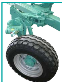
Ruota centrale di profondità e trasporto reversibile in gomma Central reversible rubber wheel for transportation and depth control
